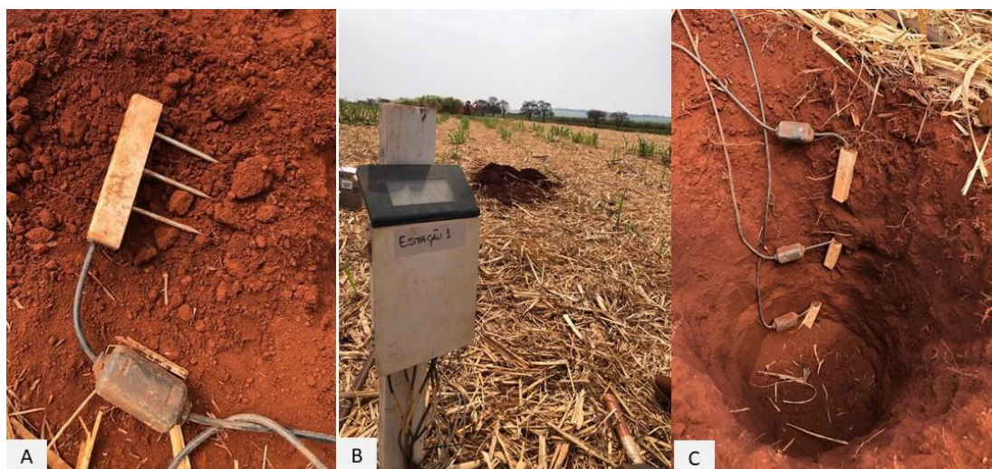
Figura 12. Sensor de capacitância TEROS 12 , fabricados pela METER Group (A); datalogger ZL6 para armazenamento dos dados (B); sondas instaladas em três profundidades: 0,2 m, 0,4 m e 0,6 m (C).
