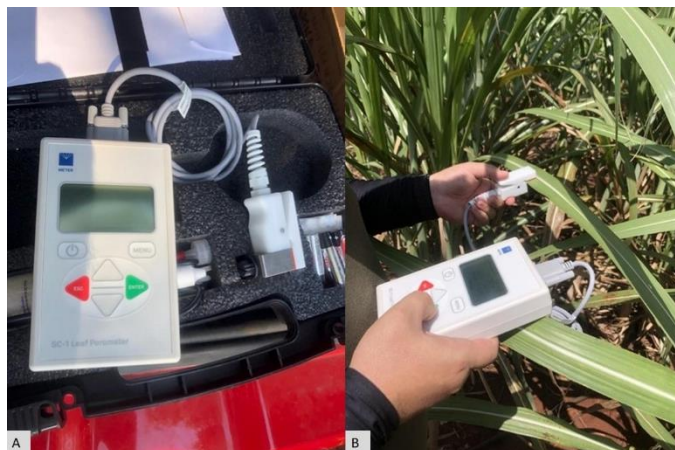
Figura 11. Porômetro portátil SC-1 Leaf Porometer , da METER Group utilizado no experimento (A) e medição na folha +3.
